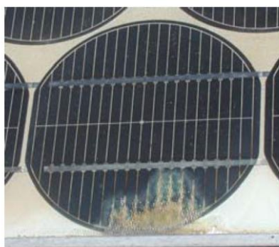
Figure 5 Délamination du module
